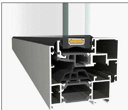
Perfilería de aluminio con marcos de 65mm y hoja de 72mm, con rotura de puente térmico.
